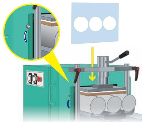
飛散防止カバーをクランプユニットの奥にあるスリットにあわせて差し込みます。
