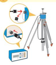
本体 (三脚部) の検出器保護カバーを外し、カールコードで表示器と接続します。
