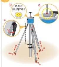
aランマーシャフトの赤い線とブロック 上面が一致するよう三脚を伸縮させ ながら、b水準器で水平レベルを出し、 c クランプで脚を固定します。
