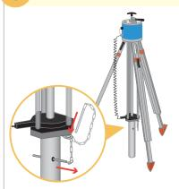
測定ポイントにキャスポルを運び、本体(三脚部)のランマー固定ピンを外します。抜いたピンは必ずピンホルダーに挿しておいて下さい。
