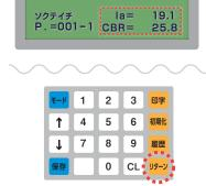
表示器に Ia 値と測定モード値が表示されますので、「リターン」キーを押しデータを確定します。 (明5かに異常な値であれば、「リターン」を押さず、再度測定してください。)
