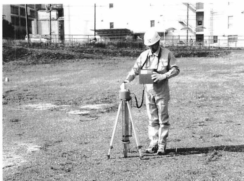
写真-2.1 衝撃加速度の測定状況
