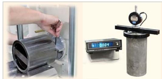
製造時、供試体と研磨盤のあたりが直角で、かつ左右に偏らないよう、すきまゲージを使って一台ずつ丹念に調整しています。また、実際に供試体を研磨し平面度を確認しています。（製品には検査証明書をおつけています。）
