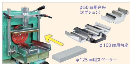
台座の組み合わせで4種類の供試体を研磨できます
