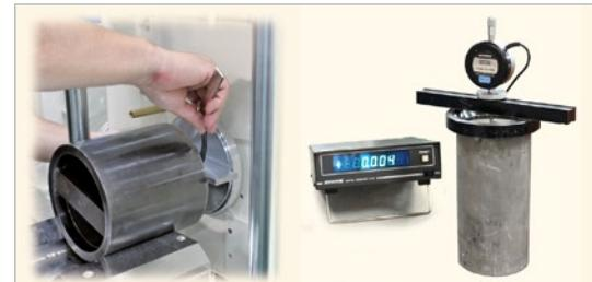
製造時、供試体と研磨盤のあたりが直角で、かつ左右に偏らないよう、すきまゲージを使って一台ずつ丹念に調整しています。また、実際に供試体を研磨し平面度を確認しています。（製品には検査証明書をおつけしています。）
