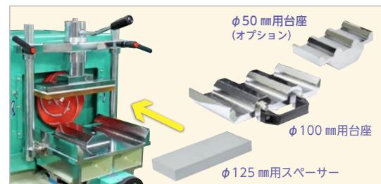
台座の組み合わせで4種類の供試体を研磨できます
