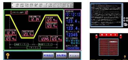
カラータッチパネルで操作・設定・試験状況確認が簡単に行えます。また、「ヘルプ画面」から供試体のセット方法や試験設定方法を確認可能です。さらに、トラブル時には異常箇所を点灯表示し、原因と対処方法も表示しますので、万が一トラブルが発生しても安心です。
