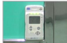
試験装置外部に酸素濃度計を装備しており、万が一、試験室の酸素濃度が低下すればアラートが鳴ります。
