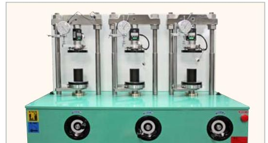
一度に 3 つの供試体を載荷しますので、試験時間が短縮でき、また独立載荷式ですので、準備のできた供試体から試験を行います。
