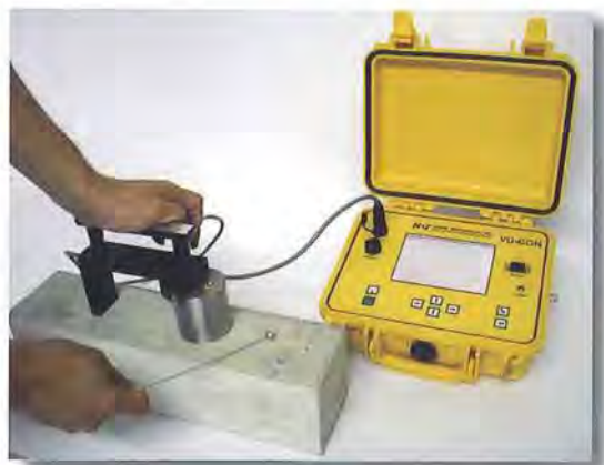
コンクリート構造物・試験体にて2個のセンサーを使用し 測定間隔(300mm)で音速を測定します。
