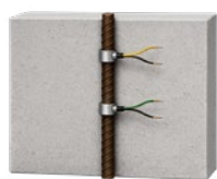
ミニセンサー 鉄筋上で自然電位 (mV) を測定
