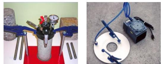
付属の室内実験キットを使えば、円柱供試体での試験が行えます。また、サクションプレートと真空ポンプを用いれば、完全非破壊で測定を行うことができます。
