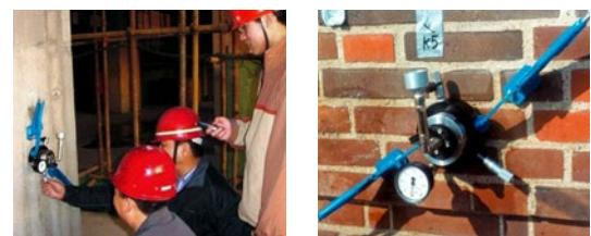
電源やコンプレッサーを使わず、現場で手軽に既存コンクリート構造物や窯業系パネルの透水性を評価できます。また、5～10分と短い時間で測定が可能です。
