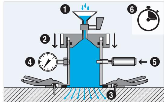
①圧力室を水で満たし、②圧力室の蓋をコンクリート表面方向に締め込み、③水を圧入します。④圧力計を確認し、⑤マイクロメーターゲージと連動したピストンを、コンクリート表面に圧入された水量分、圧力室内に押し込み、圧力を一定に保ちます。⑥マイクロメーターゲージの数値と、試験時間により、透水性を評価します。
