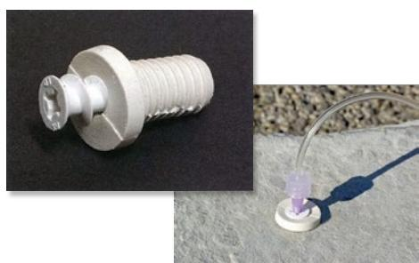
試験する箇所に、直径10mm深さ40mmのドリル穴を開け、ブロワーでコンクリート切粉を取り除きます。まずシリコンゴムプラグを差し込みます。次にプラスチックねじプラグをシリコンゴムプラグに締め込み、ドリル削孔内を密閉させます。
