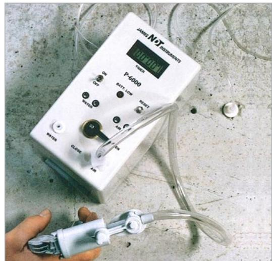
試験孔にプラグを挿入して周囲を密閉し、プラグに注射針をセットしポロスコープでゲージ圧力の低下時間を計測します。(ゲージ圧力は-55kPaから-50kPaに下がるまで計測)
