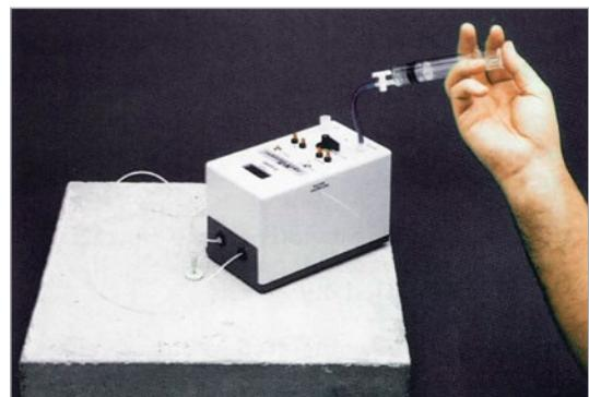
透気試験で準備された試験孔と注射針プラグを利用して水を所定の方法で強制注水し、試験孔を水で満たします。ポロスコープのセンサーとタイマーが水頭50mmの距離を移動する時間を測定します。
