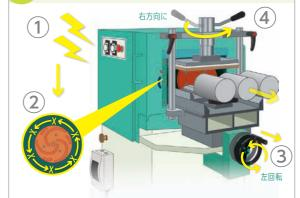
①タイマー設定時間経過後ブザーが鳴って送りが自動停止しま す。②約20秒間の仕上げ研磨後、研磨盤の回転も止まります。 ③手動送りでテーブルを戻し、④供試体を取出します。※テーブル が奥まで進むとそれ以上送れなくなります。その際は送りハンドルでテーブルを戻して下さい。
