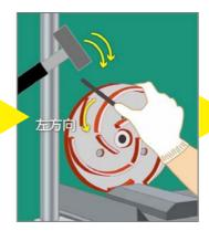
付属の六角レンチで 3 ヶ所のキャップ ボルトを緩めます。 (ボルト穴のノロを取除き、六角レンチをしっかり差込んで根本を手で押さえ、ハンマー等でレンチを緩める方向に軽く衝撃を与えます。誤って手を打ち付けないように気をつけて作業して下さい。)
