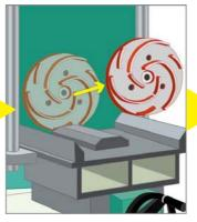
研磨盤を外します。 (なかなか外れない場合は、研磨盤 の裏側にノロが固着している可能 性がありますので、取り除いてくだ さい。)
