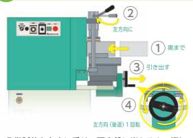
①供試体を台座に乗せ、研磨盤に当たるまで押し 込みます。②押さえレバーを左に回し、供試体を固 定します。③送りハンドルを手前に引出し (手動送 りモード)、④左に1回転させます。
