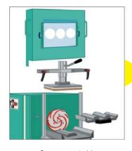
クランプユニットを外し (別紙「クイックマニュアル / セットアップ②」 参照)、続いて、前面カバー (裏面「使用後のお手入れ」参照)、台座 (使用していれば)を取り外します。
